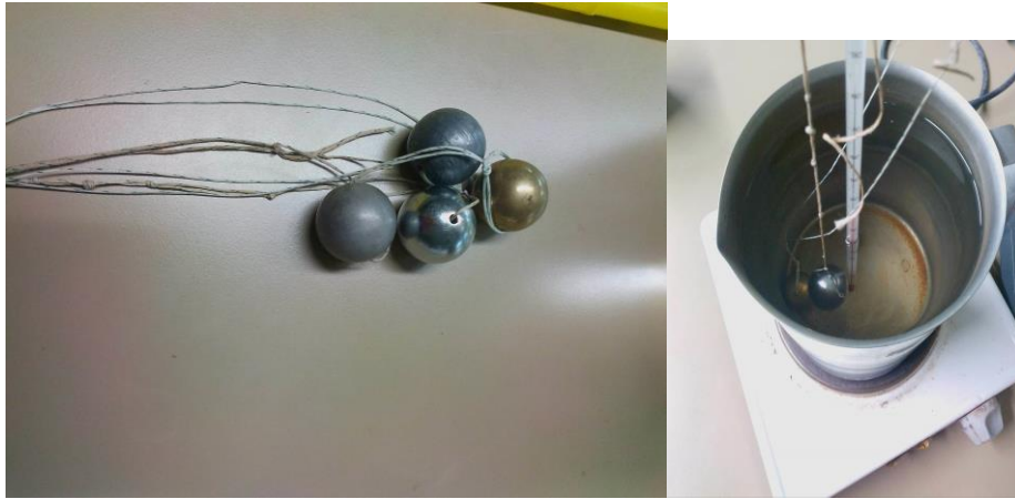
รูปที่ 1.4 นำสายผูกกับโลหะตัวอย่าง และต้มโลหะ
