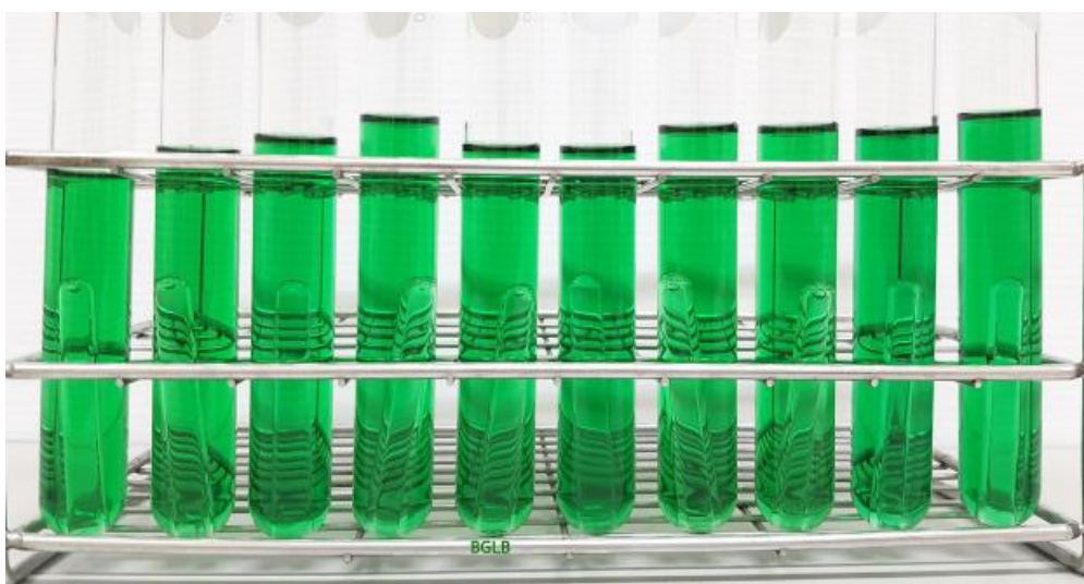
รูปที่ 2 แสดงอาหารเลี้ยงเชื้อ BGLB ในหลอดทดลอง
