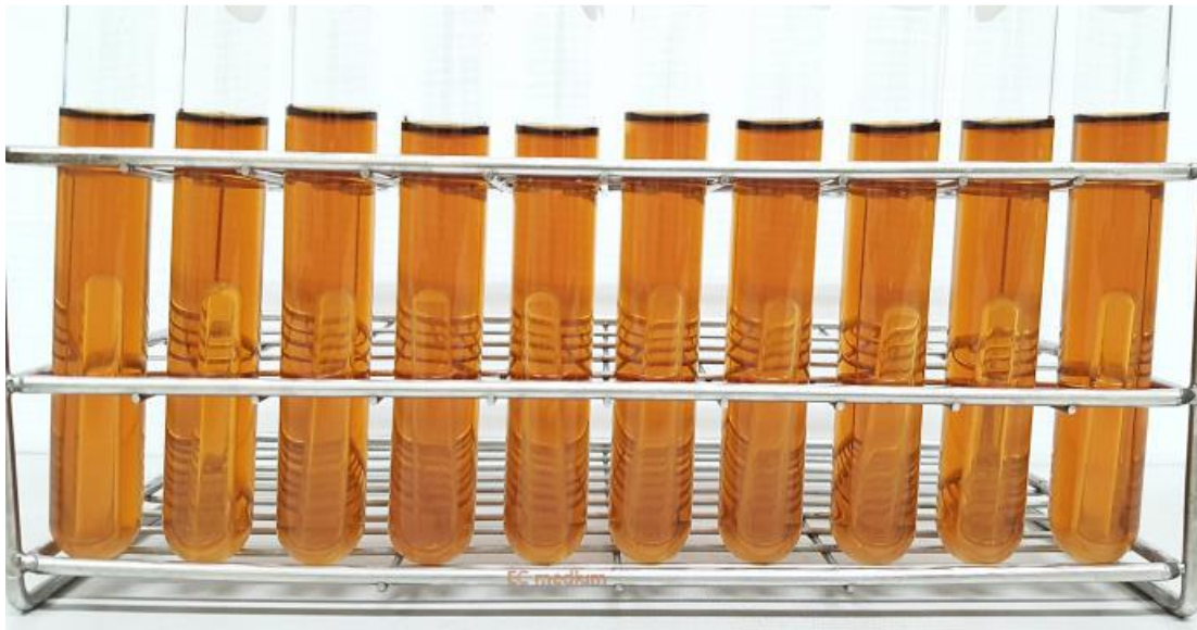
รูปที่ 3 แสดงอาหารเลี้ยงเชื้อ EC medium ในหลอดทดลอง
