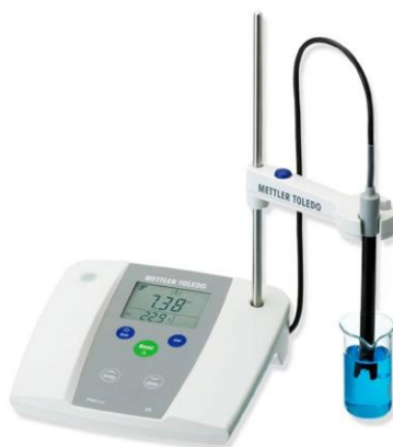
ภาพที่ 1.11 เครื่องวัดสภาพการนำไฟฟ้า (Conductivity)
